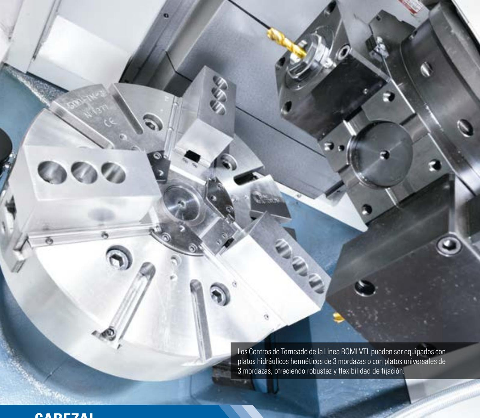
Los Centros de Torneado de la Línea ROMI VTL pueden ser equipados con platos hidráulicos herméticos de 3 mordazas o con platos universales de 3 mordazas, ofreciendo robustez y flexibilidad de fijación.
