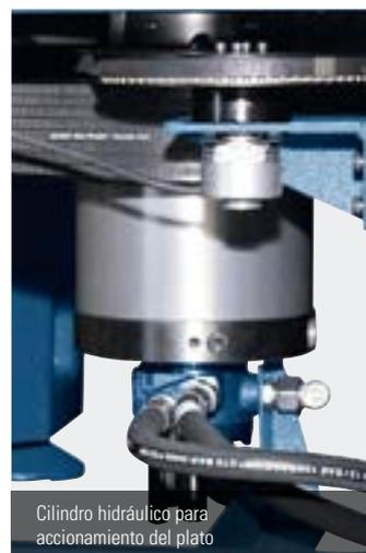
Cilindro hidráulico para accionamiento del plato
