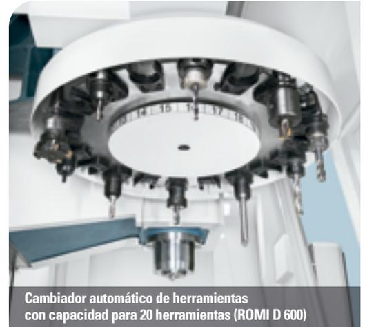
Cambiador automático de herramientas con capacidad para 20 herramientas (ROMI D 600)
