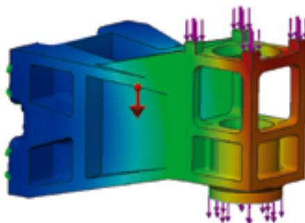
Estructura del cabezal que ofrece excelente estabilidad térmica y geométrica, rigidez y alta capacidad de absorción de los esfuerzos de mecanizado, aun durante los mecanizados pesados.
