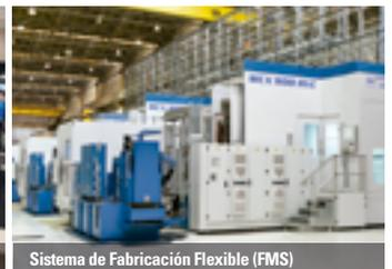
Sistema de Fabricación Flexible (FMS)
