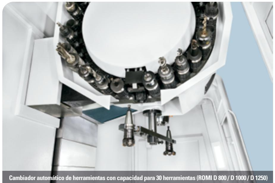
Cambiador automático de herramientas con capacidad para 30 herramientas (ROMI D 800 / D 1000 / D 1250)
