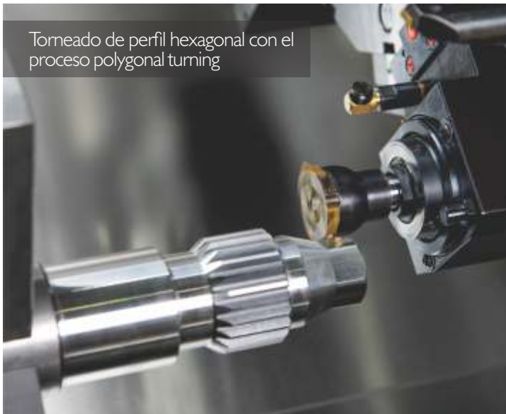
Torneado con soporte de herramientas doble y eje Y
