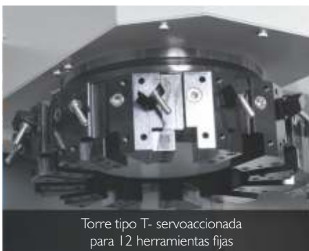
Torre tipo M- servoaccionada para 12 herramientas fijas o accionadas BMT-65
