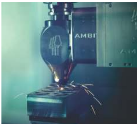
Proceso de deposición de material en el centro de maquinado ROMI D 800 HYBRID
