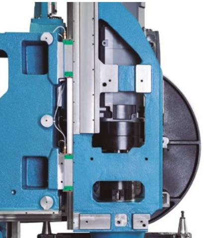
**MOTOR PRINCIPAL** Directamente acoplado al cartucho del cabezal, ofreciendo eficiencia en la transmisión de potencia y torque.
